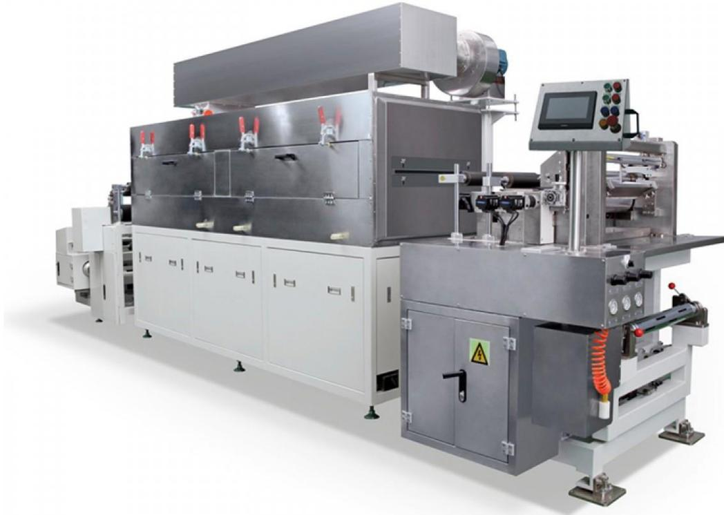
涂布设备外型尺寸及重量：尺寸 L7100\*W1210\*H1810mm
