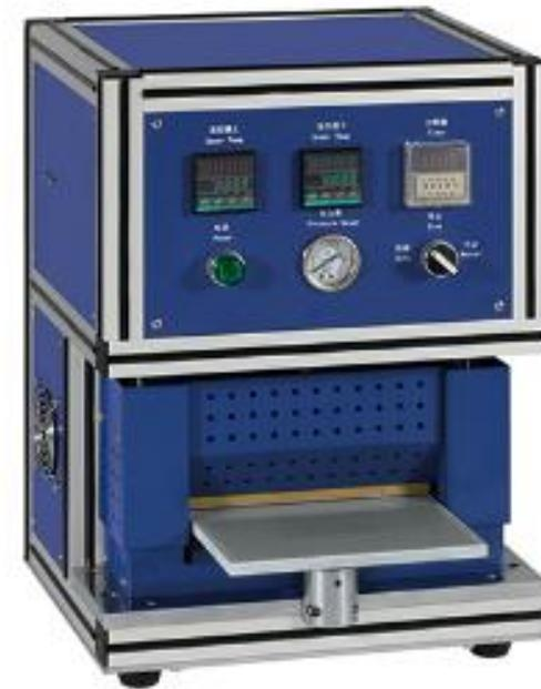
使用方法：当温度参数达到设定值时，手持电芯将电芯的封边置于封头之下对正封边位，脚踏开关起动，气缸带动下热封头下压封装，将铝塑膜加热变软接近熔融状态压合融接完成热封压边动作，手工将电芯取出完成。
