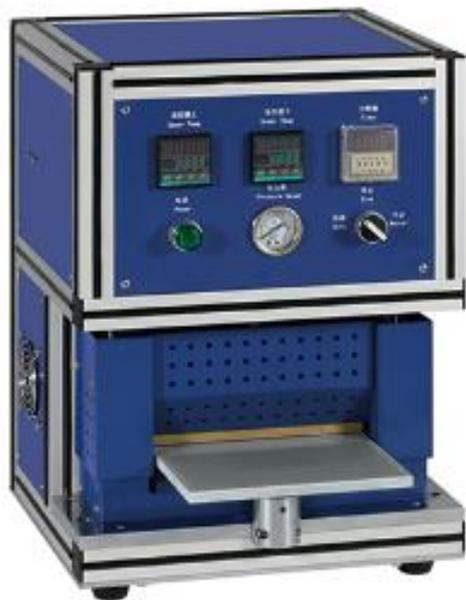
主要适用于软包装锂电池顶边、侧边的封装
